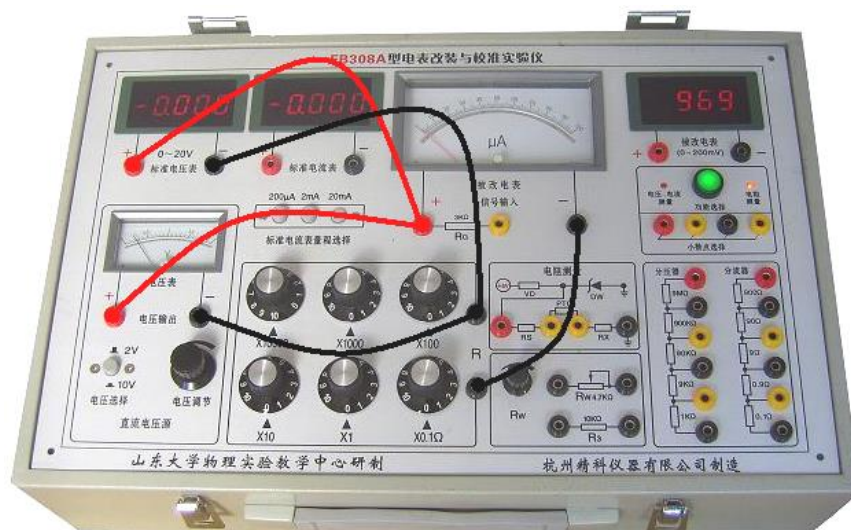
图9 用指针式表头改装电压表实验接线图
