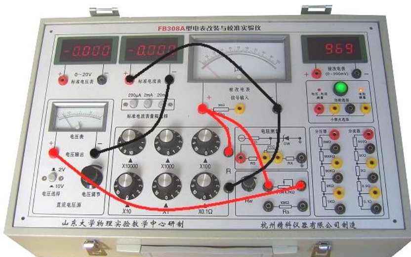
图8 用指针式表头改装电流表实验接线图
