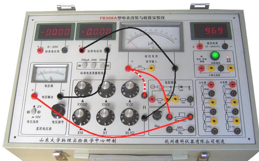
图6 用中值法测量指针式表头内阻的实验接线图
