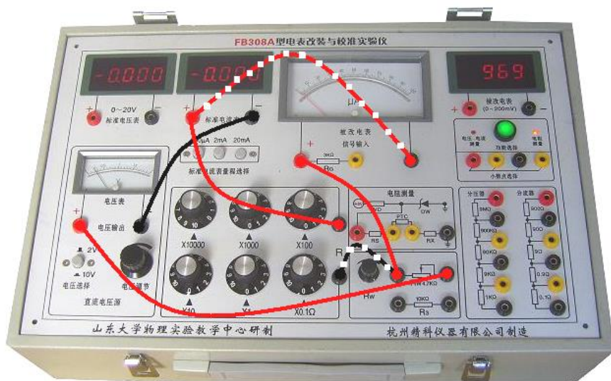
图7 用替代法测量指针式表头的内阻实验接线图
