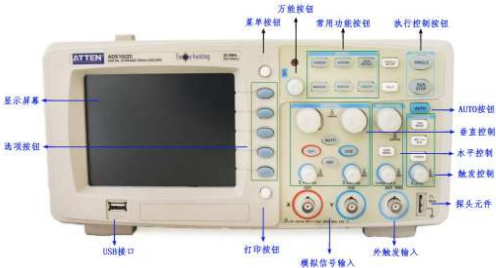
图 11.7 ADS1022C 型数字存储示波器面板图
